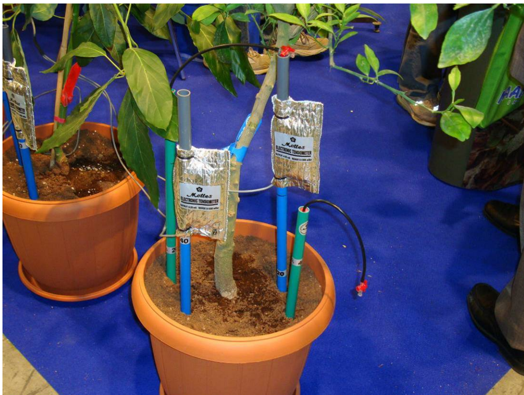
圖 11. 電子式土壤水分張力計
