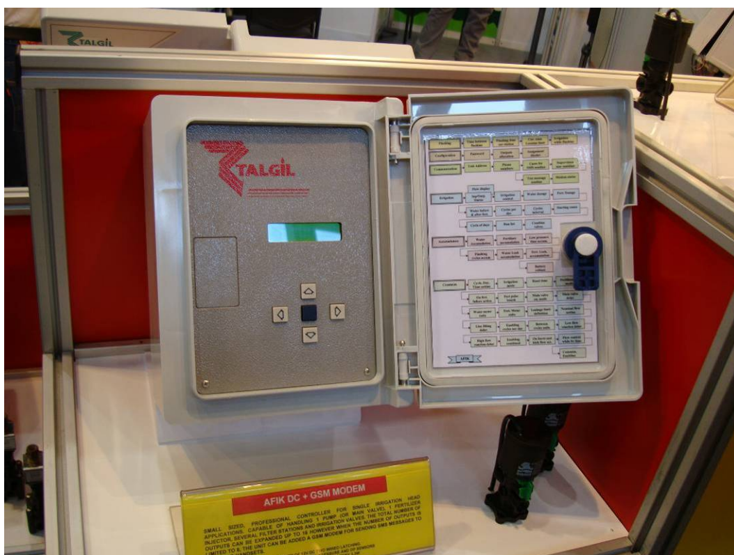
圖 13. 結合 GSM 傳輸功能的灌溉控制器
