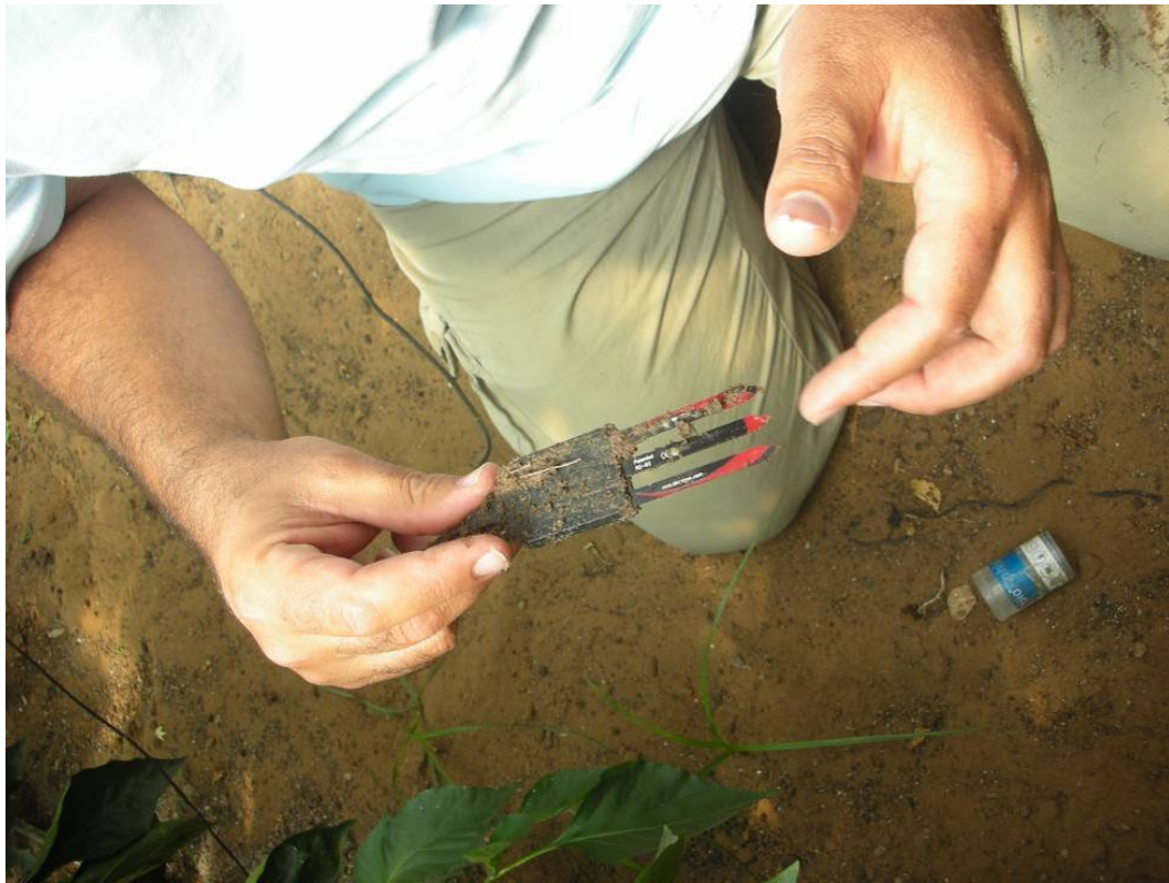
圖 26. 放置在土裡的土壤溫度、EC 值、水分偵測計
