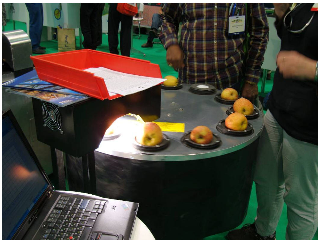
圖 3. 蘋果內部品質光電分級試驗機
