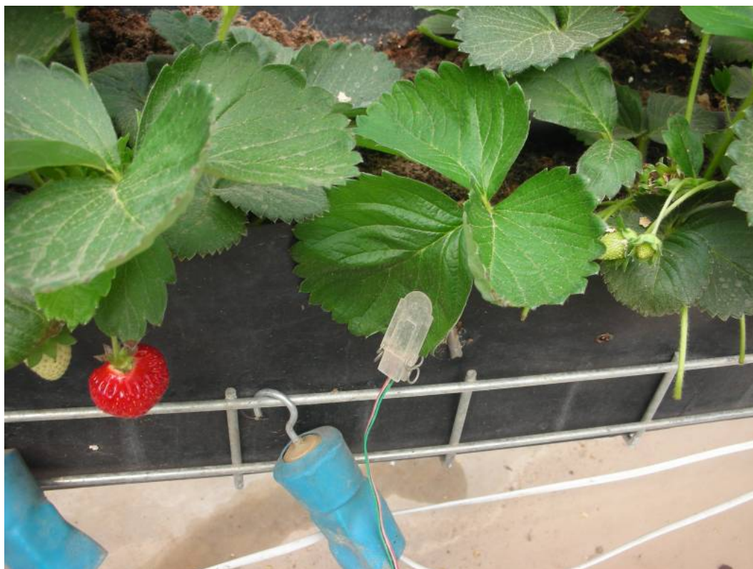
圖 51. 夾在草莓葉片上的葉片膨壓感應計
