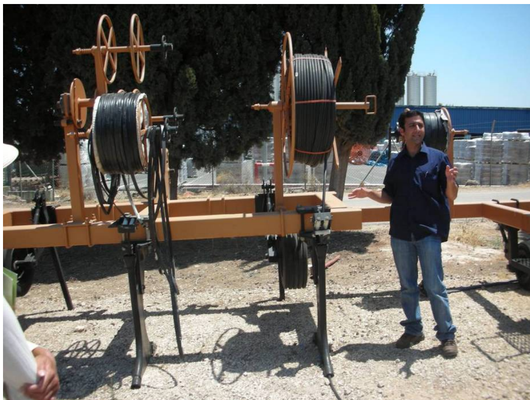
圖 47. 埋設土表下灌溉管線用的曳引機配掛配件
