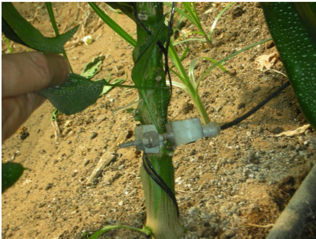
圖 25. 莖生長監控偵測計
