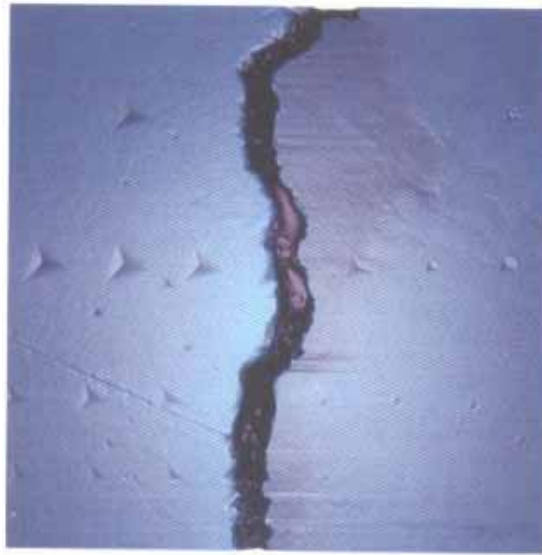
圖 17、薄膜經奈米壓痕試驗機測試後之表面壓痕形貌
