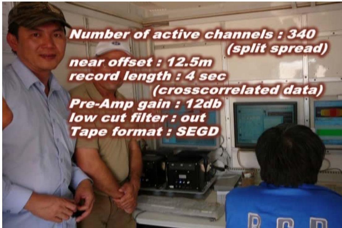
照片 6 測站震測資料收集
