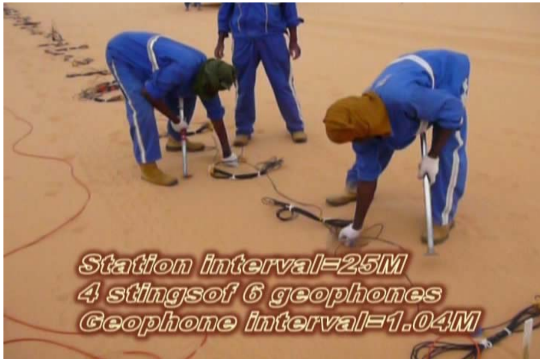
照片 14 佈署震測測線作業
