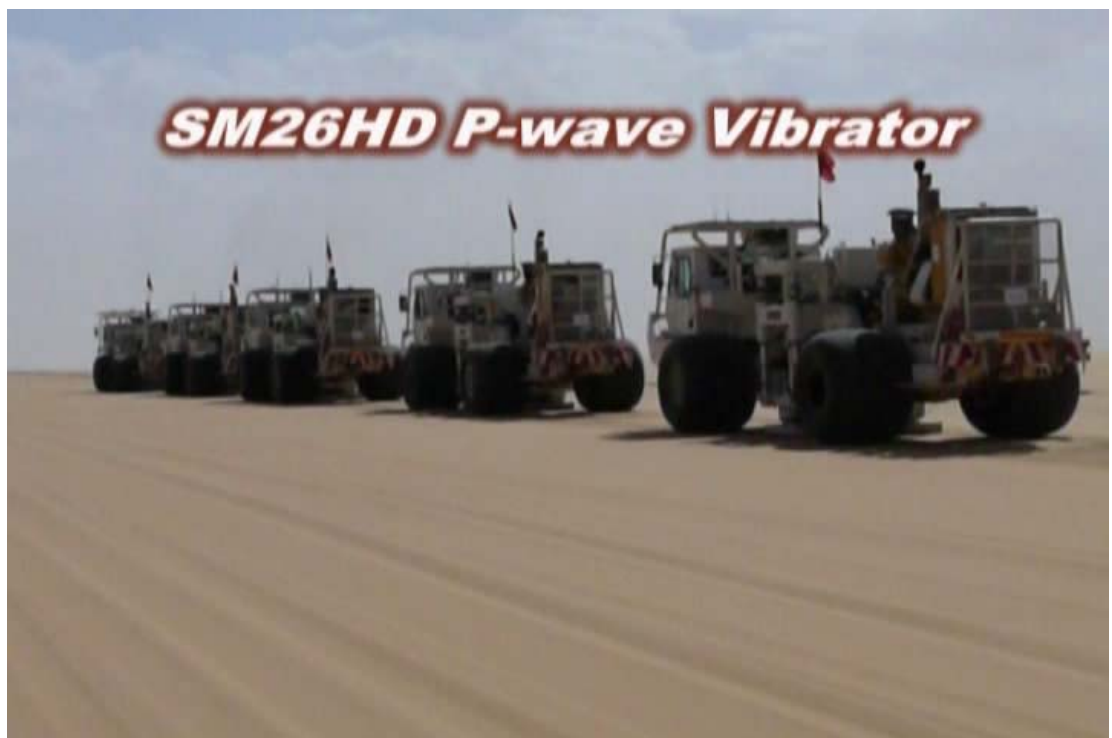
照片 9 沙漠施測震盪震源車隊
