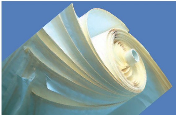
圖 16 ( 6 ) Mery-sur-Oise 淨水場奈米薄膜處理模管及捲式膜
