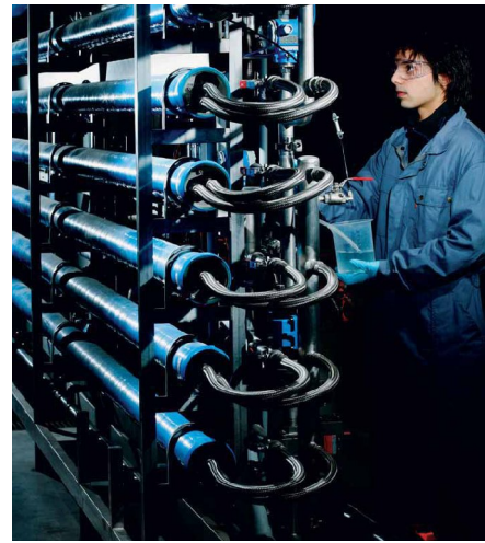
圖 10 Annet-sur-Marne 模型場試驗基地 - 薄膜處理研究設備
