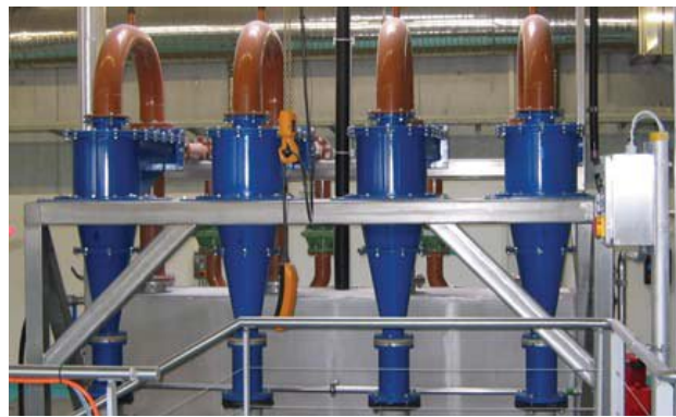
(1) Actiflo®微砂加重凝快沉設備(上)及其水力分離器(下)
