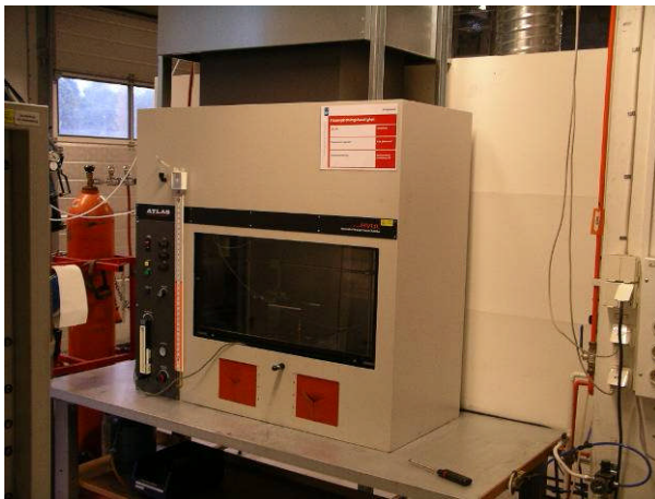
圖 17. UL 94 塑膠材料燃燒 試驗裝置
