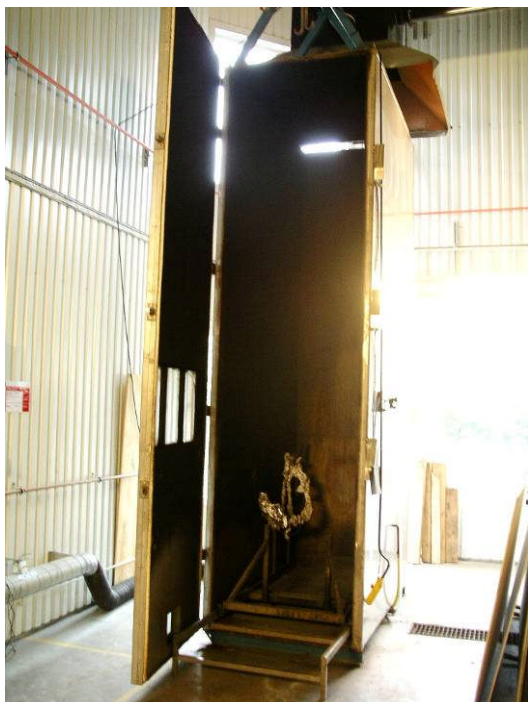
圖 12. IEC 60332-3 電線電 纜垂直燃燒試驗裝置
