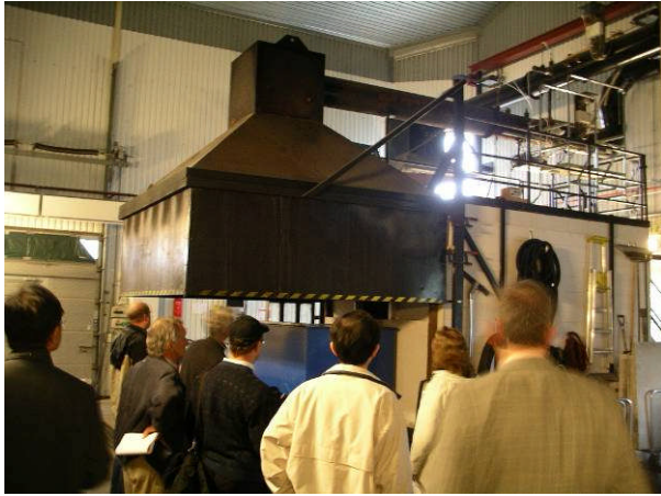
圖 9. ISO 9705 房間火災實驗裝置(集煙罩及燃燒室)
