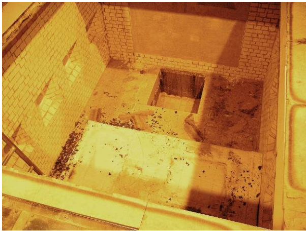
圖 19. 3m x 5m 樓板及梁耐 火試驗爐
