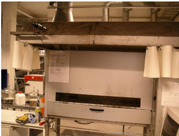
圖 16. ISO 9239-1/DIN 4102-14 地板輻射熱及發煙 性試驗裝置
