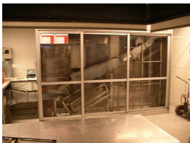
圖 13. 傾斜火焰延燒試驗 裝置
