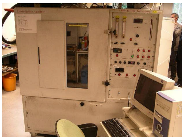
圖 14. ASTM E662/ISO 5659 發煙性試驗裝置
