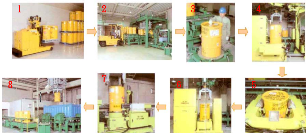
圖 3.3-9：低放射性廢棄物桶外運前檢查流程
