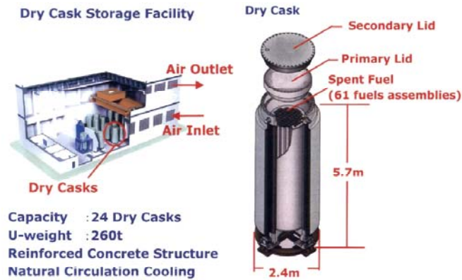
圖 3.4-9：用過核燃料 Dry Cask 概要
