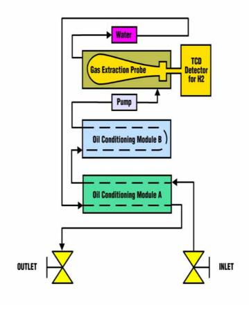
油在恆溫下(35℃)經過儀器內脫氣裝置,氣體會脫出經偵測器偵測氫氣及一氧化碳濃度,油再經水分計偵測水分。
