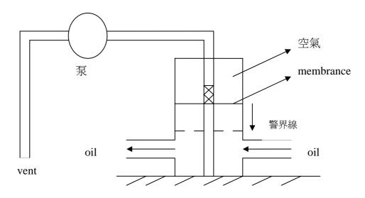
在 inlet valve 與 outlet valve 間有 automatic bubble removal 設備,當油管中有氣泡,氣泡會在滲透膜上方累積使油位下降,當下降到警界線,就會有訊號通知泵將空氣抽走,如此可避免空氣進到變壓器中。
