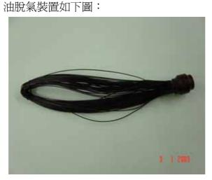
它是 Tefon fibers,每一根 fiber 像髮絲般細,可萃取油中氣體。油中氣體由油擴散至 Tefon fibers 再到偵測器示意圖
