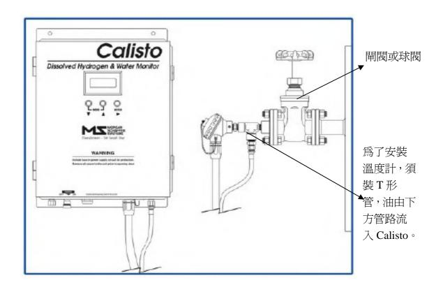
油閥必須爲閘閥或球閥,溫度測棒才能穿過,由於有本體油溫,可用來計算本體油%RS,此數據可用來評估變壓器絕緣紙含水量。
