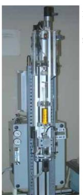
Powertech 公司設計之樣品前處理 自動化設備 HSPA (Headspace sample preparation apparatus)
