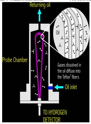
氫氣及一氧化碳偵測器皆爲熱傳導偵測器,它們對其他可燃性氣體的反應很小。油溫維持在35℃的理由是PTFE管氣體滲透的特性較爲固定,故可測到穩定的值,不會產生上下起伏的現象,而不易看出氣體成長趨勢。
