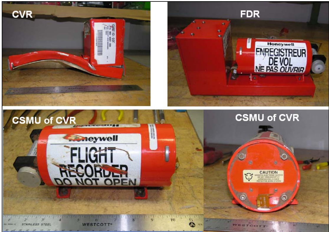
圖2 Gol Airlines,一架 B737-800與EMBN600XL, 於亞馬遜河上空發生碰撞後 FDR與CVR外觀檢查(資料來源TSB)
