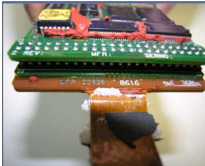
圖3. 去除CSMU記憶體電路板表面附著層(資料來源TSB)
