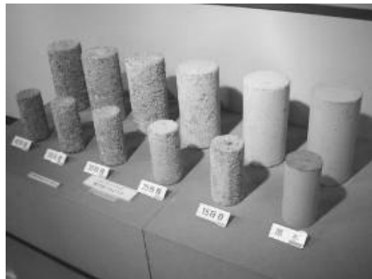
⇧ 草津溫泉強酸之影響-混凝土構造物腐蝕
