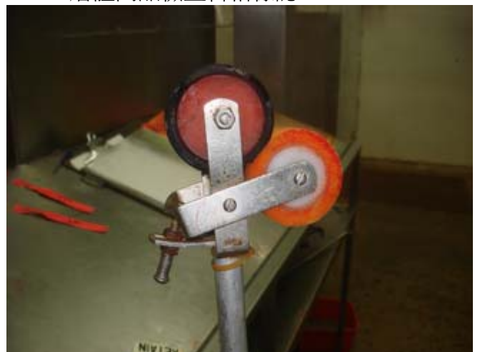
圖 68. 『Goodchild Abattoirs』小型屠宰場滾輪式肉品檢查合格章側面觀
