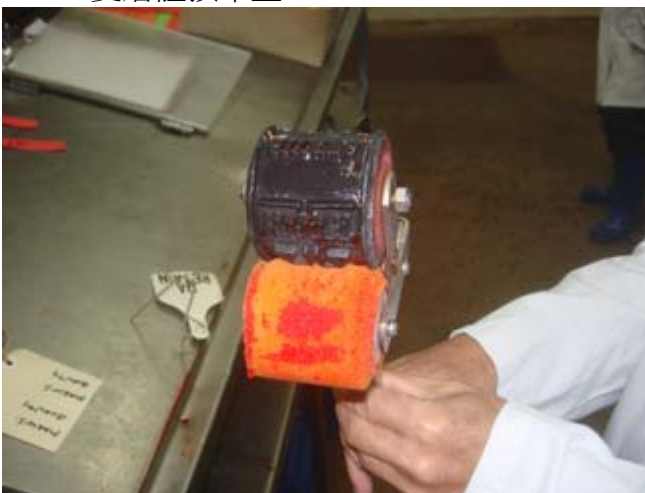
圖 67. 『Goodchild Abattoirs』小型屠宰場滾輪式肉品檢查合格章正面觀
