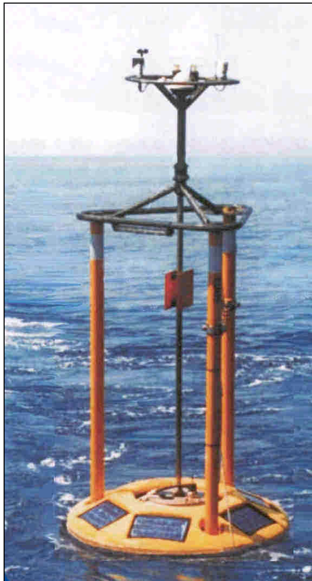
圖 30 OCEANOR 一般型量測浮台現場觀測實景
