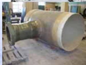
GRP Pipe 應用於壓力鋼管案例(三)
