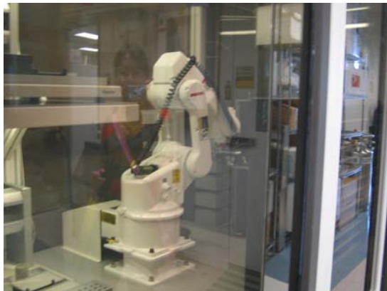
顯微雷射撷取儀，能自行將膠上之目標蛋白質從膠上撷取下來。(MCW)
