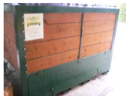
堆肥製造槽－利用微生物分解
