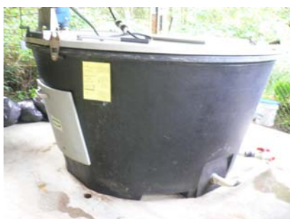
堆肥製造槽－利用溫度控制
