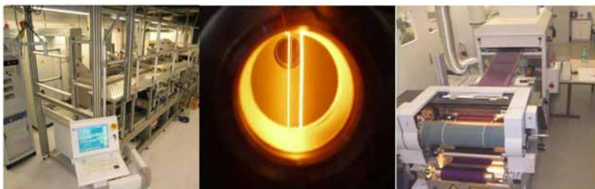
圖 7. Flexcellence 計畫使用 MW PECVD(左圖)、HWCVD(中圖)及 VHF PECVD(右圖)三種設備於捲揚式機台生產矽薄膜太陽能電池
