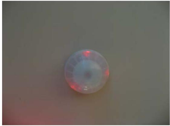
圖 48 溫度感應型保全探測器 Security detector
