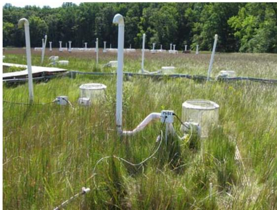
圖 92 沼澤地二氧化碳偵測槽裝置設備
