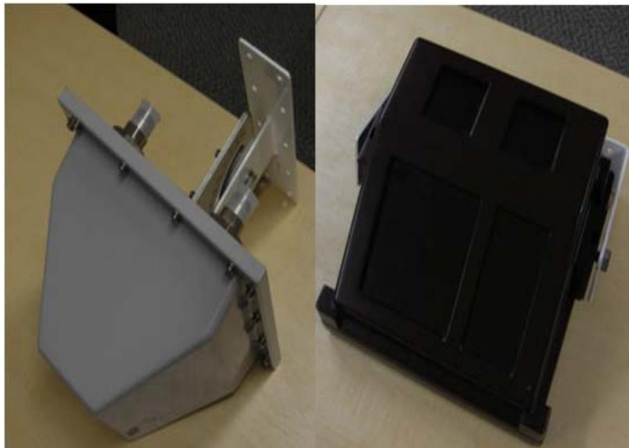
圖 4 交通路況發射裝置(左邊為 DSRC 2.4GHz、右邊為紅外線)
