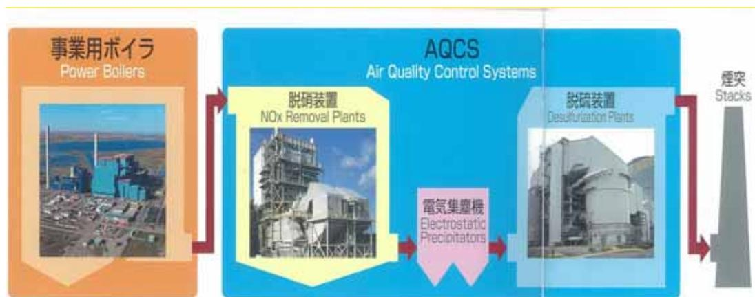
圖一：鍋爐及空氣品質控制系統
