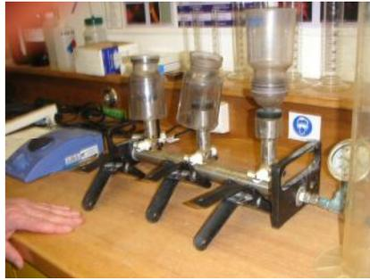
圖 14 濾膜濃縮固定法設備(與本公司相同，目前該實驗室已不使用)
