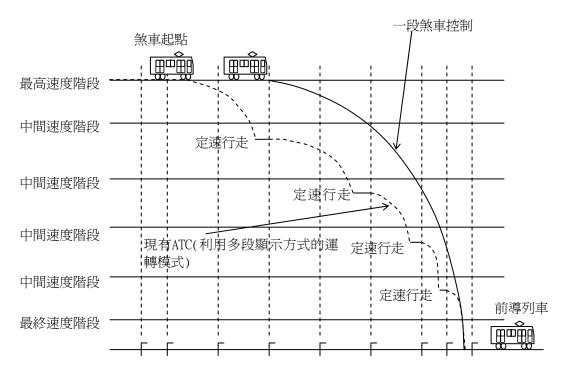
一段煞車控制方式原理圖
