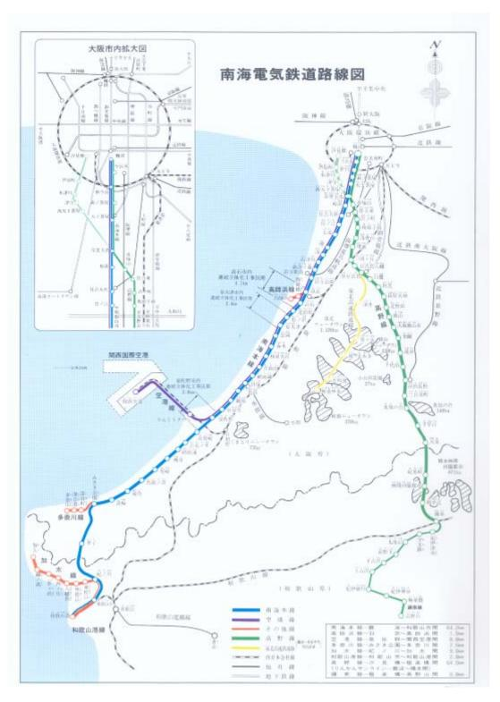
另為減少建設及營運成本,自機場連絡橋另一端之臨空城站至關西空港站之 軌道道旁設施之設備及控制完全一致,採共用軌道不同月台之方運作,南海鐵道 停靠 1、2 月台, JR 西日本則停靠 3、4 月台,自動收費系統亦各別設置,並由 JR 西日本負責測試、監控及系統維修,軌道部分則由關西國際空港株式會社負責維護,南海鐵道則依彼此約定分擔相關費用,南海鐵道所屬車輛之車載號誌系統必須同時適用南海本線及空港線。
