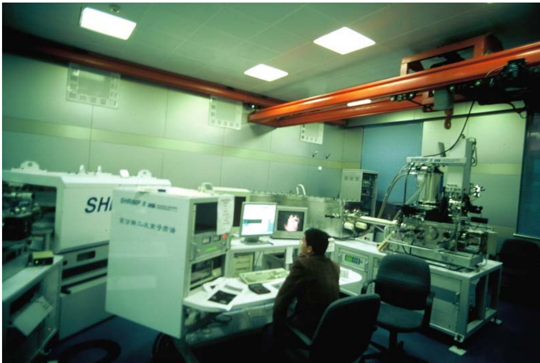
圖十、北京離子探針中心之高解析度二次離子探針質譜儀 SHRIMP 操作情形
