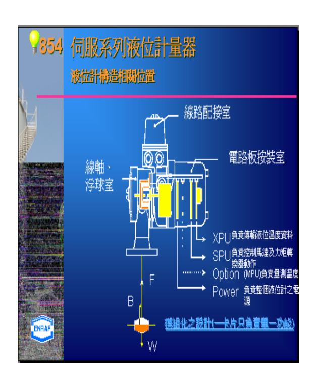
圖十三、伺服式液位計構造
