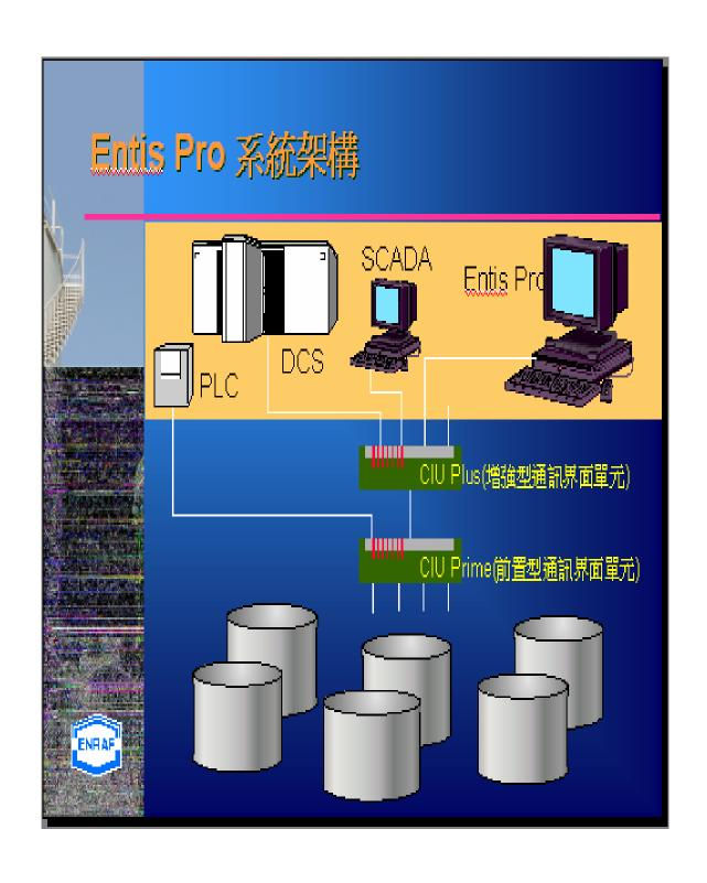
圖十四、伺服式液位計通訊界面單元系統架構
