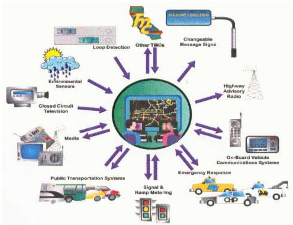
圖 2-31 運輸管理中心建置之電子設備與資料蒐集/傳輸方式
