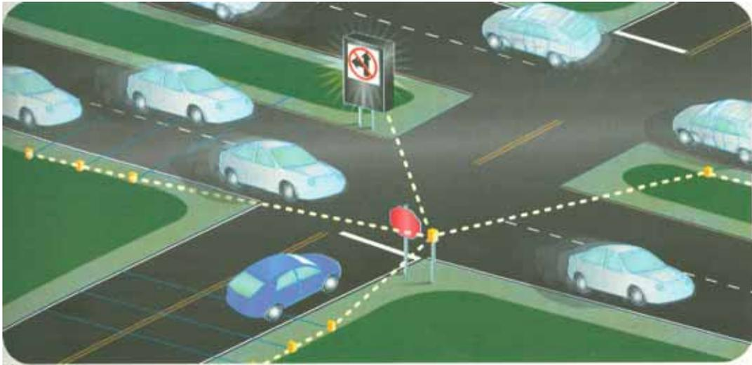
圖 2-25 停車再開標誌輔助系統示意圖
