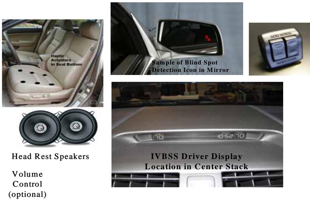
圖 2-17 IVBSS 輕型車 (Beta Vehicle) 人車介面整合
