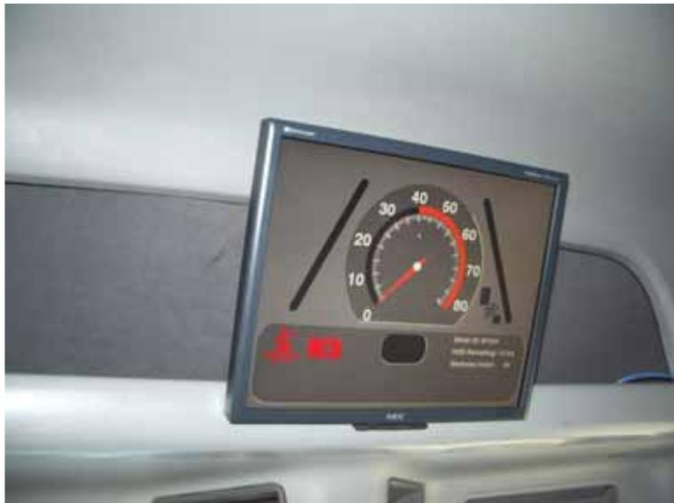
圖 2-3 貨車車上監視系統特製儀表板
