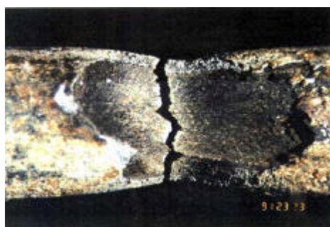
圖 2.6 典型鋼索圓錐破壞形式
