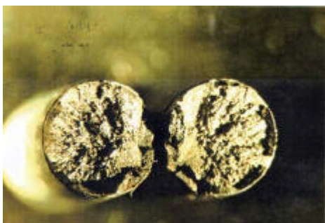
圖 2.4 頸縮現象的破壞形式
