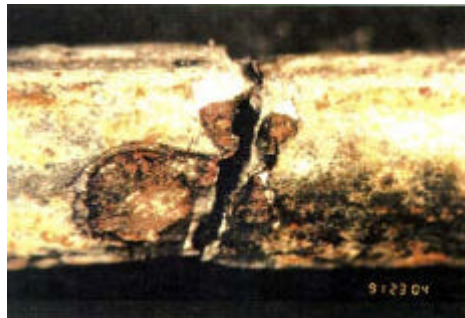
圖 2.4 頸縮現象的破壞形式
