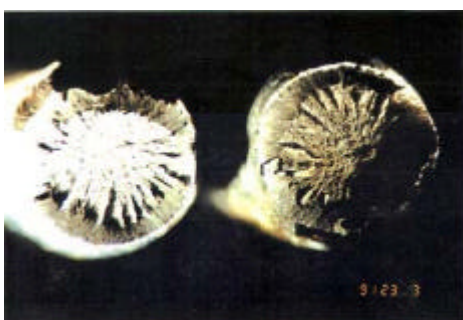
圖 2.6 典型鋼索圓錐破壞形式
