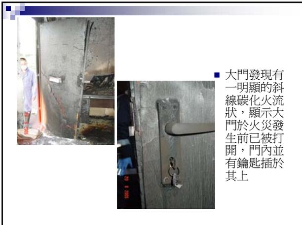
■ 大門發現有一明顯的斜線碳化火流狀，顯示大門於火災發生前已被打開，門內並有鑰匙插於其上
