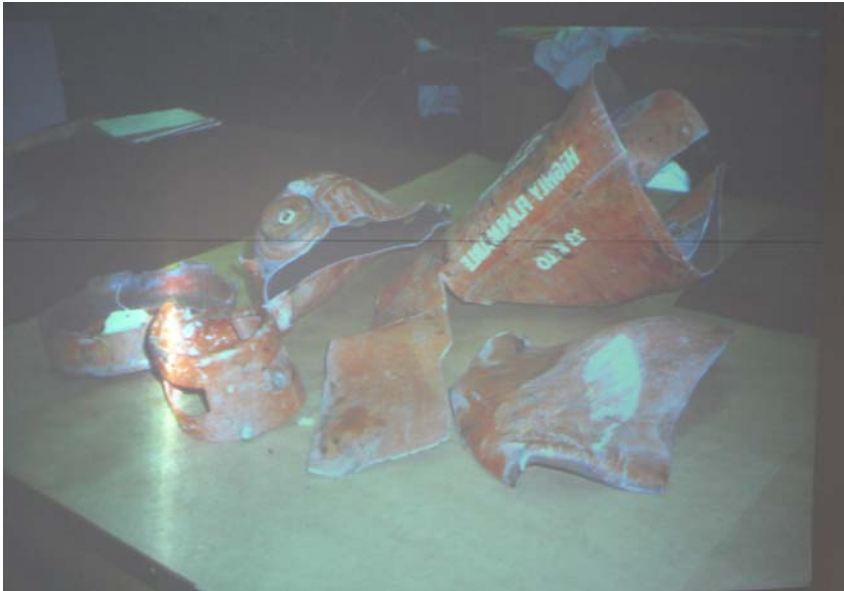
【相片 74】乙炔桶爆炸殘骸，偷竊的人死於這場火災，因為產生爆炸的關係，主因是因為用錯易燃易爆氣體。
