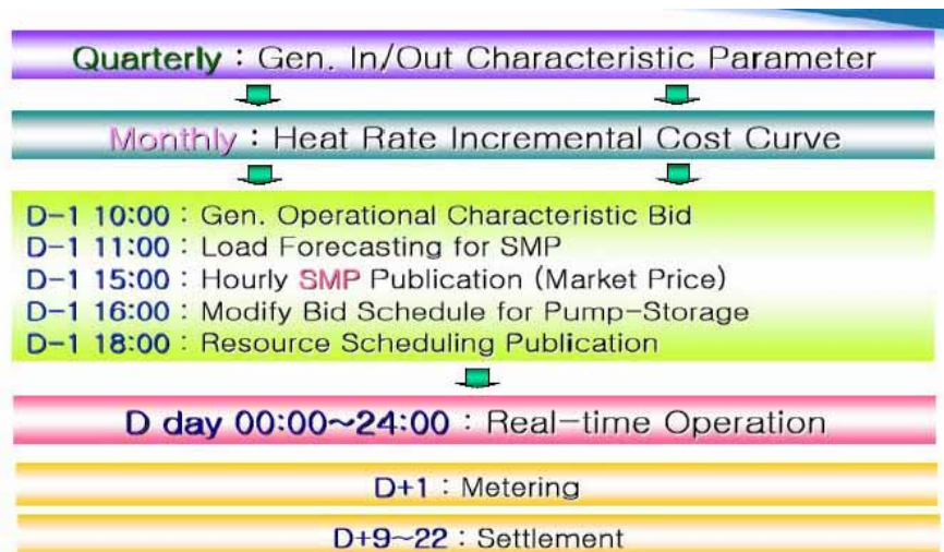
圖 10 電力市場配合調度排程之作業程序
