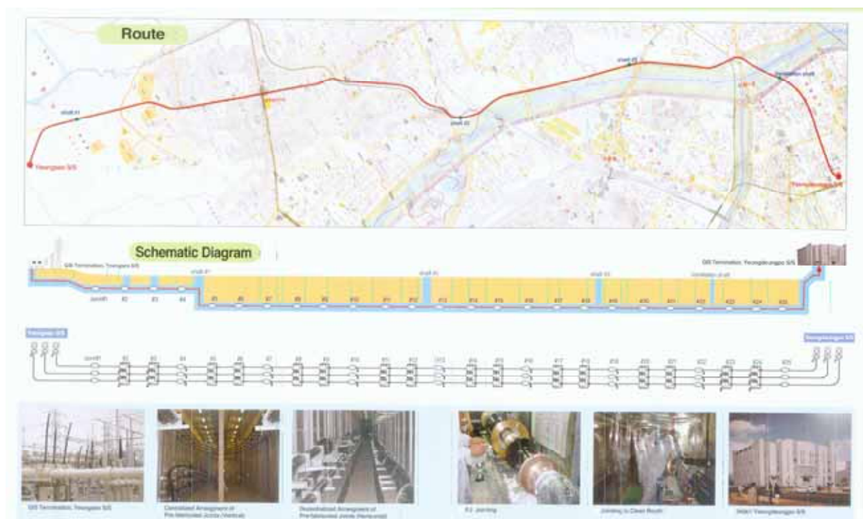
圖 1 永西~永登浦 345KV 地下電纜線路
