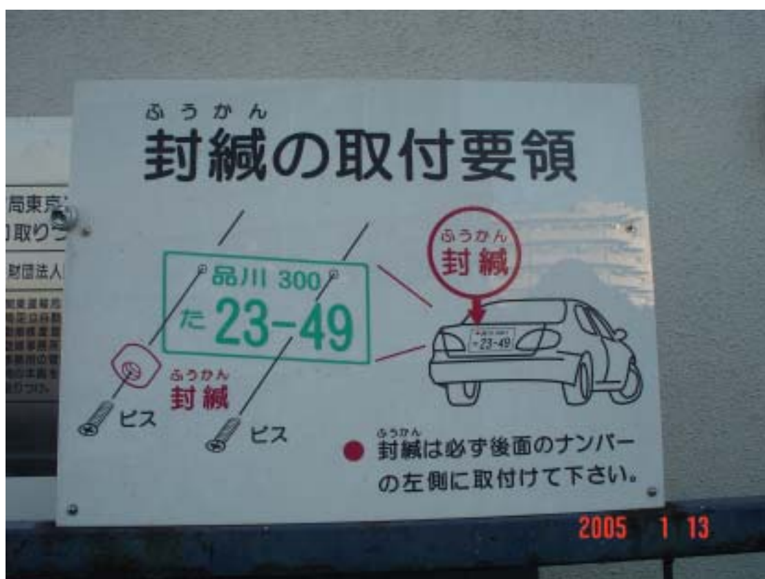
照片十七：日本汽車號牌封鉛安裝圖。
