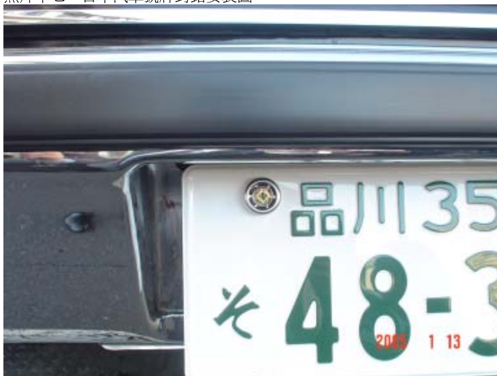
照片十八：日本汽車號牌封鉛安裝圖。
