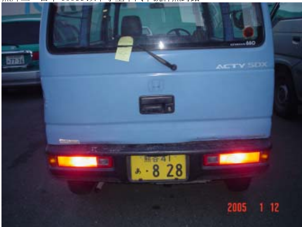
照片四：日本 600CC 以下小型車汽車號牌無封鉛。
