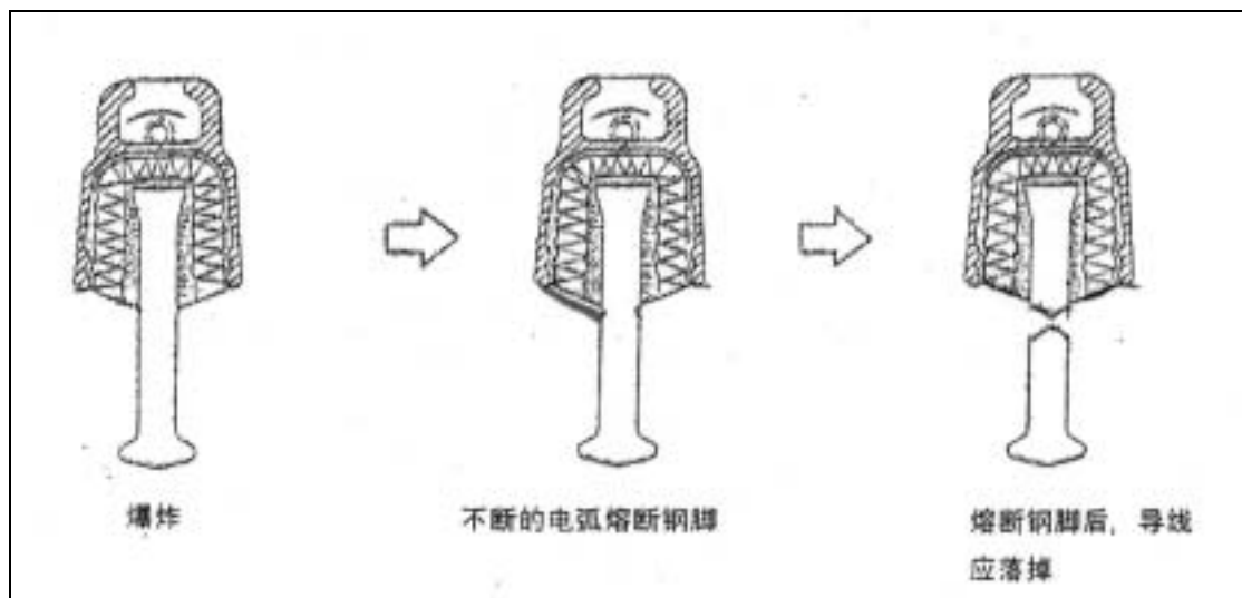
圖 5-9：電弧熔斷鋼腳引起導線掉落
