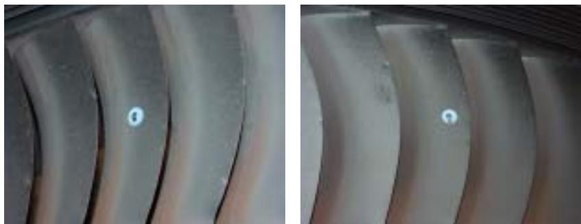
其中左圖為運轉 8 年的結果，右圖為運轉 9 年的結果，兩者均為低壓段噴嘴葉片，從照片中可以看出
