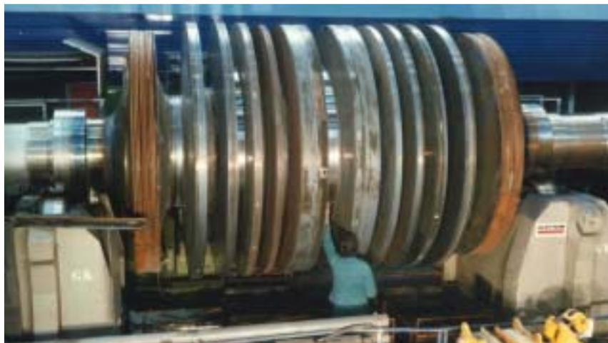
下圖為焊接式低壓轉子安裝 57"長末級動葉片 (LSB) 的實際照片：
