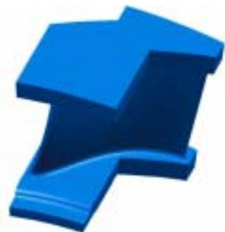
靜葉片設計概要與動葉片相似，也更具強度與效率，更能配合動葉片葉形，但不可拆卸，葉形如上圖。此種葉片應用於 Platform
