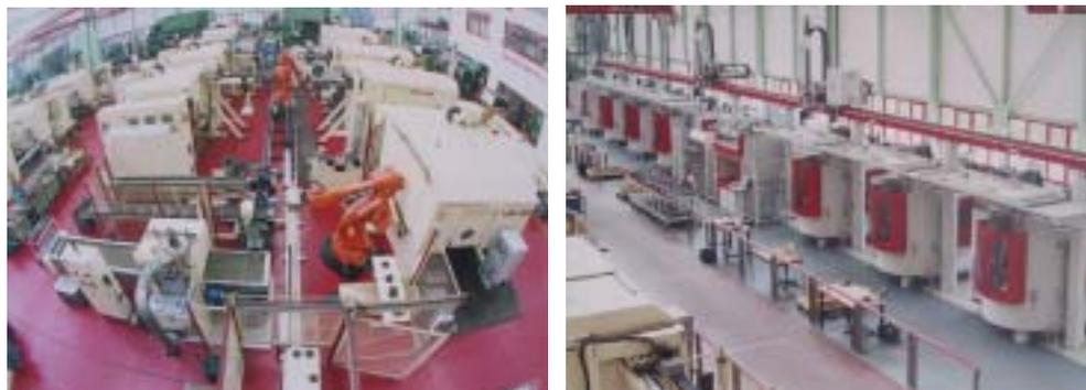
該廠葉片設計與生產均已電腦化，經由設計專用軟體針對葉片的物理特性如幾何形狀、應力分析…等等得到最佳尺寸與形狀的葉形，此即高級的電腦輔助設計（CAD）；而這最佳設計可直接由設計人員下達指令給現場生產機器，驅動其對原料或半成品加工，這些機器全為電腦數值控制（CNC），這個電腦驅動過程即電腦輔助製造（CAM），連工件粗胚的幾何量測亦為自動執行。綜觀其生產型態可以說是 CAD 與 CAM 的最好註解，現場加工機器根本不需操作人員，幾乎是全自動生產，工件取送透過機械人（Robot）轉換，工作人員在製程中只負責監視加工機器的工作情況有無特殊狀況？另外就是整批鍛件原料及成品運送，也因此整體廠房看起來十分乾淨簡潔。
