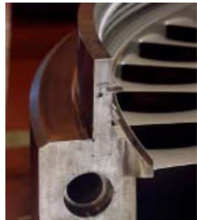
下頁上圖為軸向間隙遮蔽式汽封（左側是葉尖部份、右側則為葉根部份）：
