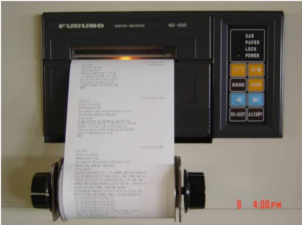
(六)、窄頻帶直接印字機 (Telex Over Radio 無線電傳) 適用於 A4 海域除了 GMDSS 外，還有一項課程 - AIS 及 VMS。船上裝設 AIS 並和避碰雷達連線，可知鎖定船隻的所有資料(目標船需註冊 MMSI: Maritime Mobile Service Identify, 水上行動業務識碼)。
