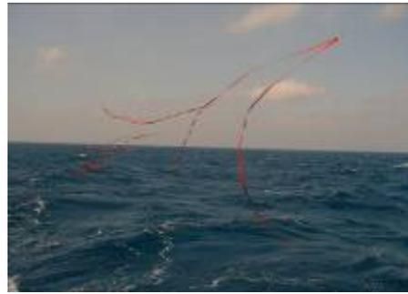
(二) 鮪延繩釣投繩作業與避鳥繩之糾纏測試,測試結果所有漁具均能順利通過避鳥繩
