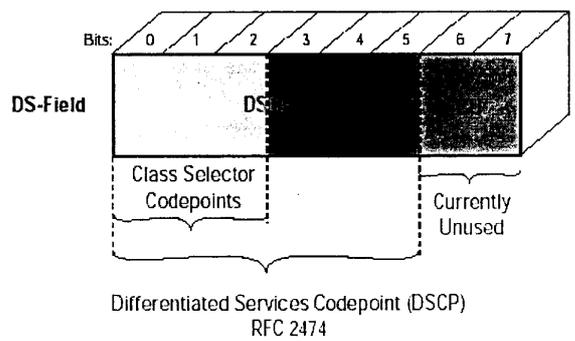
如此一來網路設備上僅須執行幾個簡單的 classification 動作，並且不用保持如 Intserv 所需的 per flow soft-state 狀態，網路設備的 QoS 效
