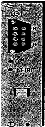
圖5.7 balise驅動板的前方面板
