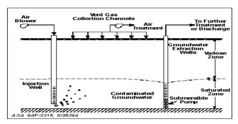
圖二:抽除處理 (Pump & Treat)及注氣法 (Air Sparging)
