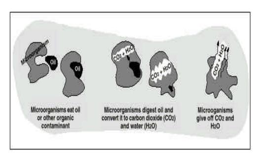
圖一:微生物分解油污染機制、流程
