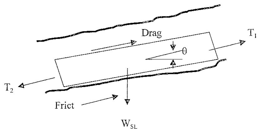
在任何的直線孔部份，左邊的拉力  $T_2$  可由靜力平衡圖分析求得：
