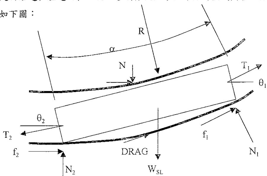
在任何的弧形孔部份，左邊的拉力  $T_2$  可由靜力平衡圖分析求得：
