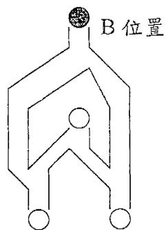
③提拉測驗串，J-型梢自“B”點移至“C”點位置，測驗器關閉。
