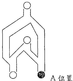
②下至預定位置，施以適當坐重，經短時間之延滯後J型梢自“A”點滑至“B”點位置，測驗器開啟。
