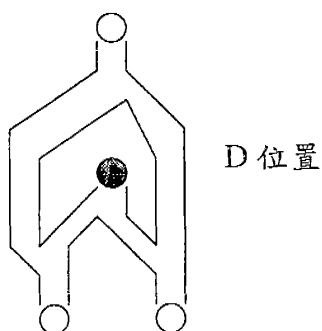
⑤提拉測串，J-型梢自“D”點移至“A”點位置，測驗器仍關閉。
