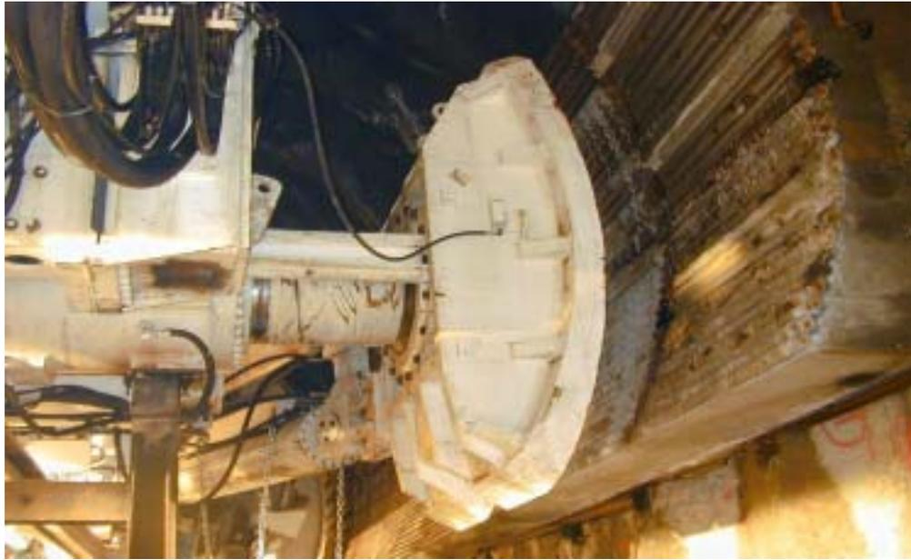
照片十三、反力座張開抵住側壁岩盤照片
